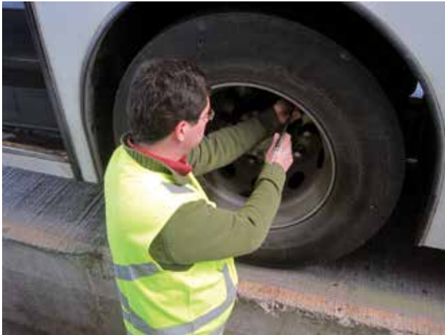
Figura 5. Revisa periódicamente la presión y estado de los neumáticos.
